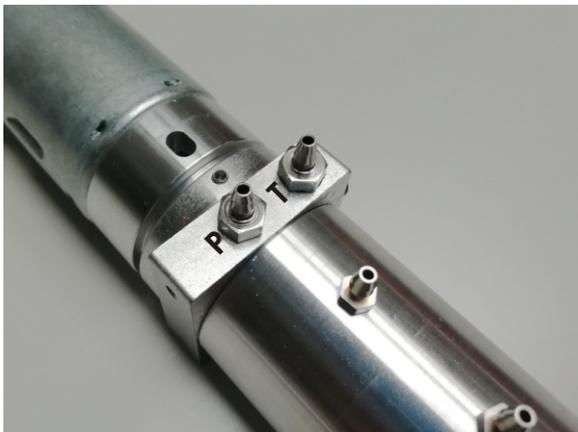
Auf dem Pumpenkörper befinden sich zwei Anschlüsse. Der linke Anschluß (mit "P" gekennzeichnet) liefert das Drucköl, der rechte mit "T" gekennzeichnete Anschluß leitet das zurückströmende Öl in den Tank zurück.
