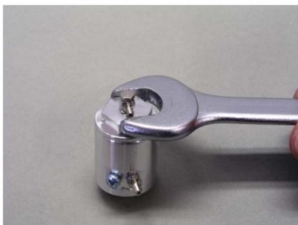
Zum öffnen der Filtereinheit wird ein Maulschlüssel mit Schlüsselweite 17mm benötigt.
