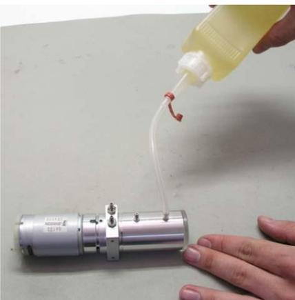
Nach dem Reinigen setzen Sie bitte den Tank wieder an die Pumpe, bauen den Filter wieder zusammen und schließen Sie alle Schläuche wieder an. *Bauen Sie sie aber noch nicht wieder fest in Ihr Modell ein.* Füllen Sie nun die Pumpe zu etwa 2/3 mit neuem Hydraulik-Öl ...
