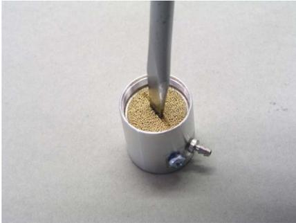
Im Innern befindet sich der Filtereinsatz. Schrauben Sie bitte auch diesen mit einem großen Schlitzschraubendreher heraus.
