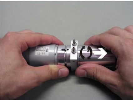
Der Tank kann durch eine Dreh- und Ziehbewegung vom Pumpenkörper abgezogen werden.
