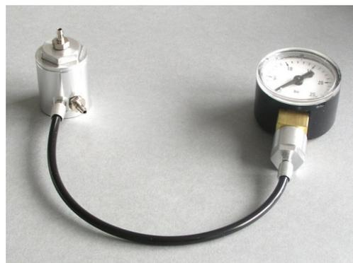
Das so vorbereitete Manometer kann dann in den Filter eingeschraubt werden .
