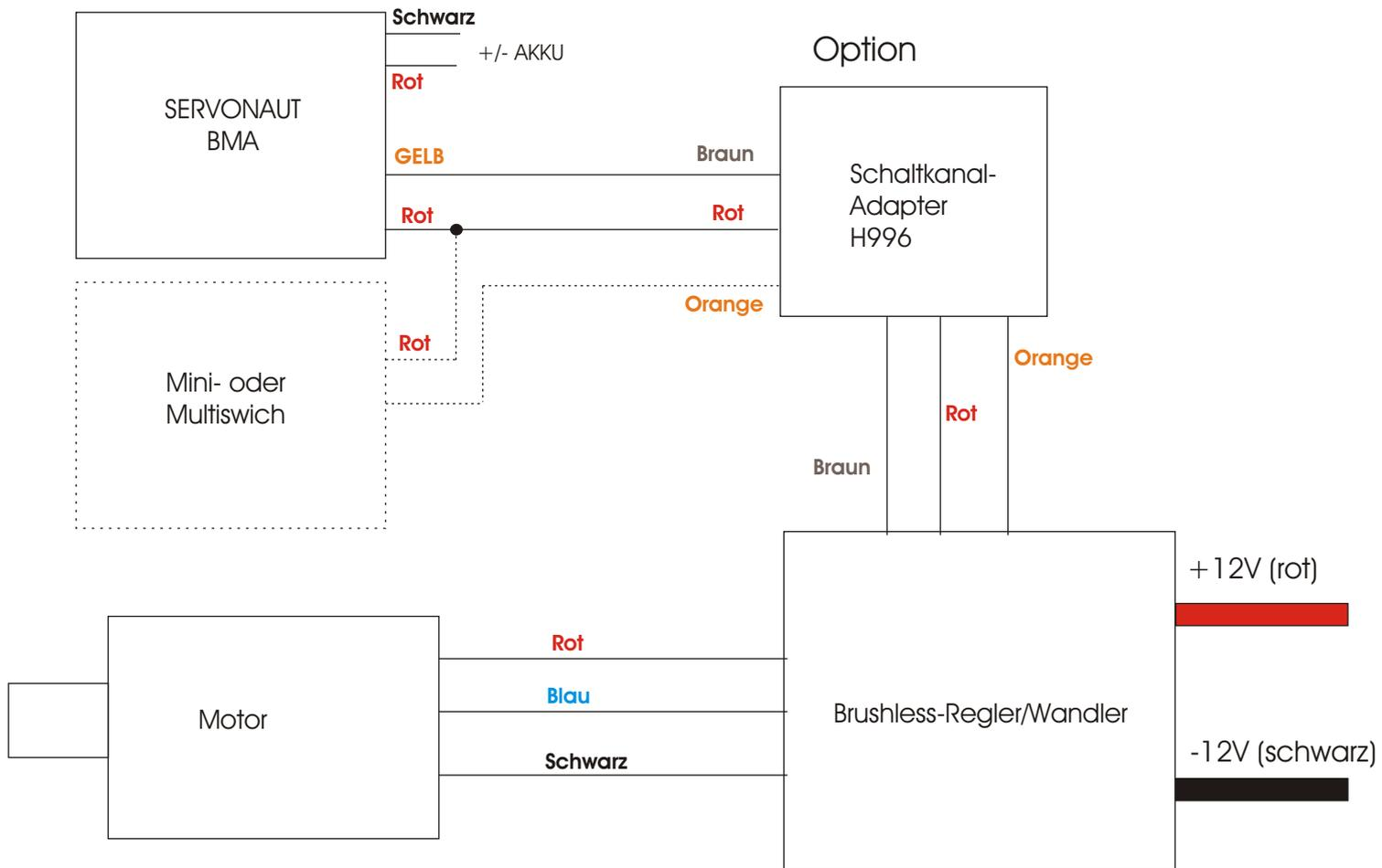
Mit dem optionalen Schaltkanaladapter kann unser Brushlessmotor an einem Pumpensteuerbaustein (z.B. SERVONAUT BMA) angeschlossen werden.
